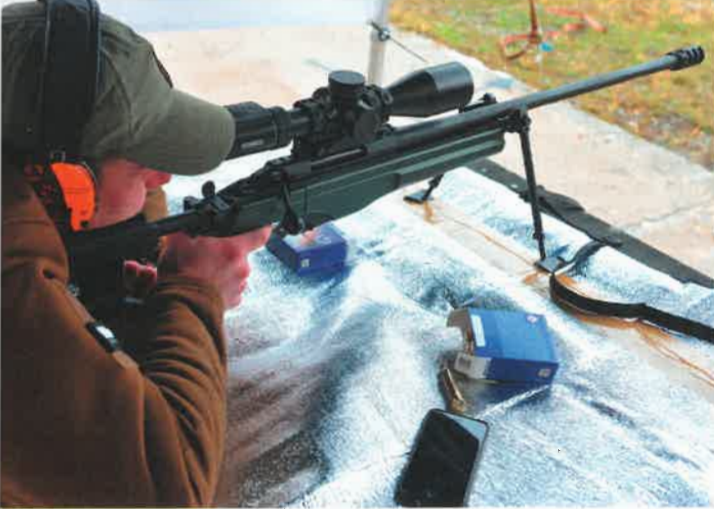
Oben: Das M7Xi IFS 4-28 x 56 ist für einen langen Augenabstand von 90 mm ausgelegt.
