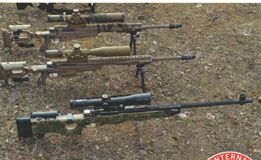
Oben: Alt und Neu – Vorn ein Scharfschützengewehr G22 mit Zielfernrohr 3-12 x 56 gefertigt von der Hensold AG und Zweibein von Accuracy International Limited, dahinter zwei Scharfschützengewehr G22A2 mit M5Xi 5-25x56 MTC LT LPF - TreMoR3 Zielfernrohren der Steiner-Optik GmbH und BT46-LW17 Atlas Bipod Zweibein von B&T Industries L.L.C.
